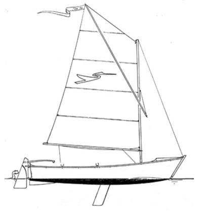
Knickspanter mit schrägem Steven und V-Boden vorn, formstabilem Hauptspant und rundem Gleitboden achtern, offenes Deck. Rumpfform
