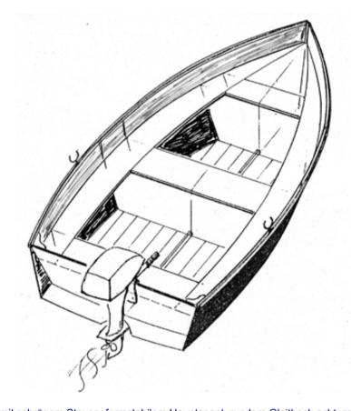
Knickspanter mit schrägem Steven, formstabilem Hauptspant, rundem Gleitheck achtern. Viele Einsatzmöglichkeiten. Rumpfform
