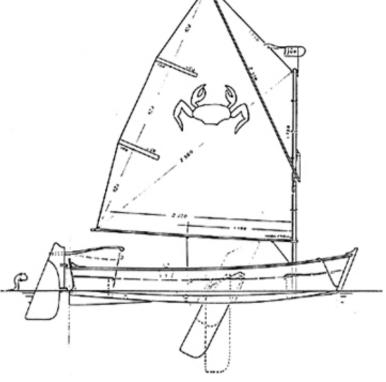
Flacher Knickspanter mit schrägem Steven, formstabilem Hauptspant und rundem Gleitheck. EInfach zu bauen und zu handhaben. Rumpfform
